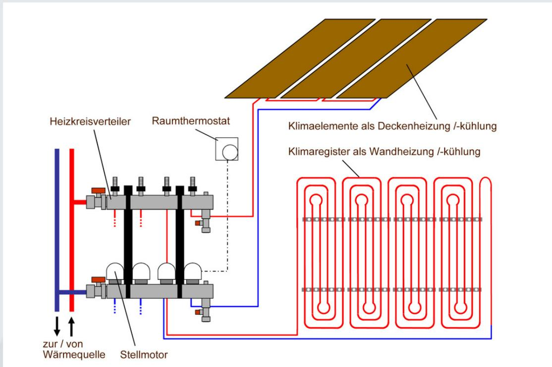
Die fertigen Heizflächen werden an den Heizkreisverteiler angeschlossen. Die Regelung der Wandheizung erfolgt über Stellmotoren, die für genau die Temperatur sorgen, die Sie am Raumthermostat einstellen.
